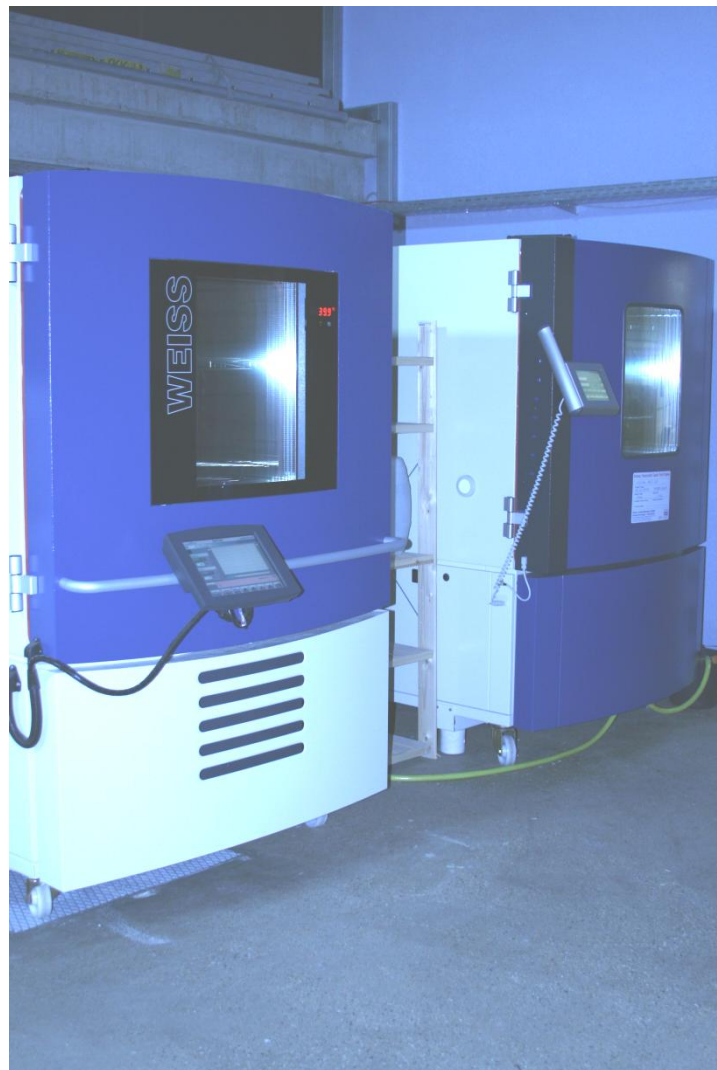
Bild 8: Klimaschränke zur Konditionierung der Proben.
