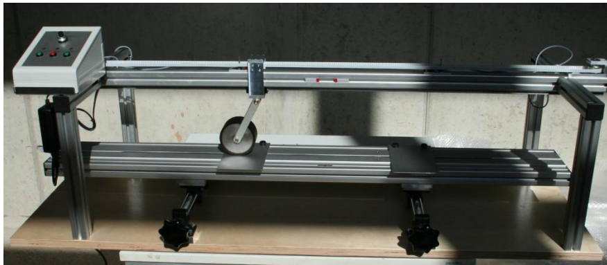
Bild 4: Elektronisch steuerbare Andruckmaschine zur Verklebung der Proben.
